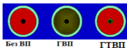
Рисунок 2 – Геометрия твэлов (без ВП, ГВП и ГТВП) [The geometry of the fuel rods (without the BAs, HBA, and NHBA)]
