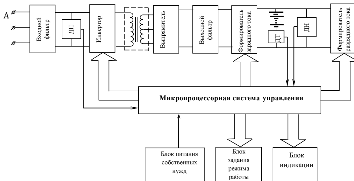
Рисунок 2 – Блок-схема заряд-разрядной станции [Block diagram of a charge-discharge station]
