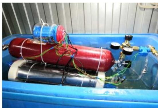
Рисунок 12 – Условия проведения эксперимента, демонстрирующего погружение и всплытие макета аппарата в техническом бассейне [Conditions for the experiment demonstrating the immersion and ascent of the apparatus model in the technical pool]
