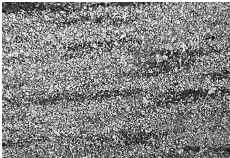
Рисунок 1 – Ликвационная неоднородность поковок из стали 10ГН2МФА (более темные участки содержат больше углерода и сильнее легированы), \times 100 [Liquidation heterogeneity of forgings from 10GN2MFA steel (darker sections contain more carbon and are more alloyed), \times 100 ]
