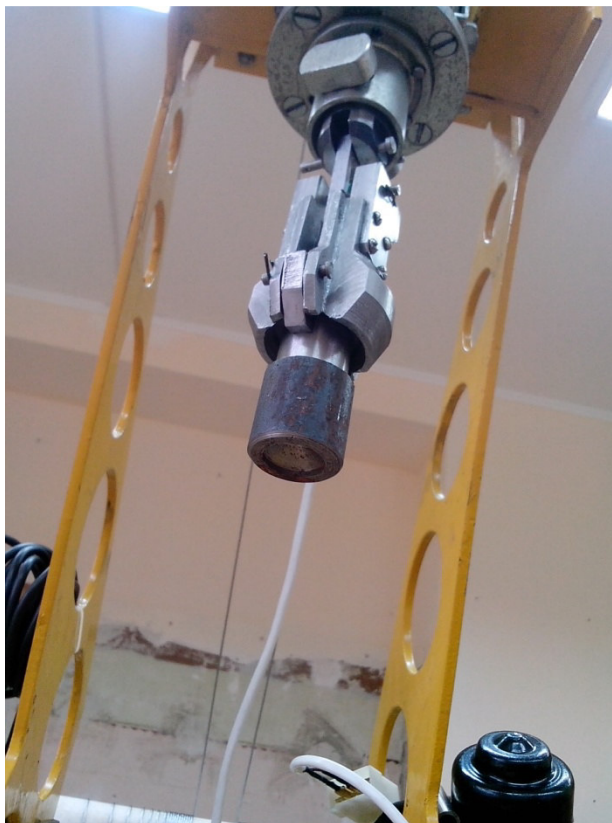
Рис. 3. – Захват автоматический универсальный в процессе операции с цилиндрическим объектом
