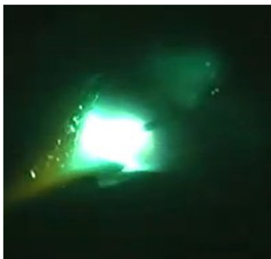
Рис. 2. – Фото дуги при сварке порошковой проволокой
