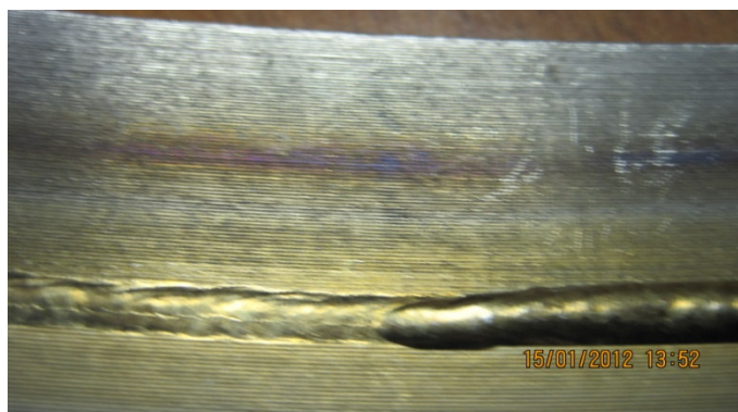
Рис. 8. – Корневой валик при сварке неплавящимся электродом
