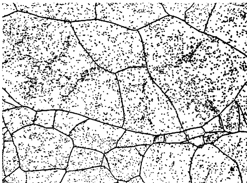
Рис. 5. – Субструктура монокристалла вольфрама в исходном состоянии; \times 80
