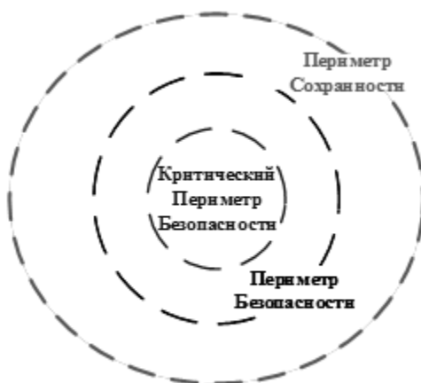
Рисунок 1 – Определение опасных зон вокруг источника излучений [Identification of hazardous areas around radiation source]
