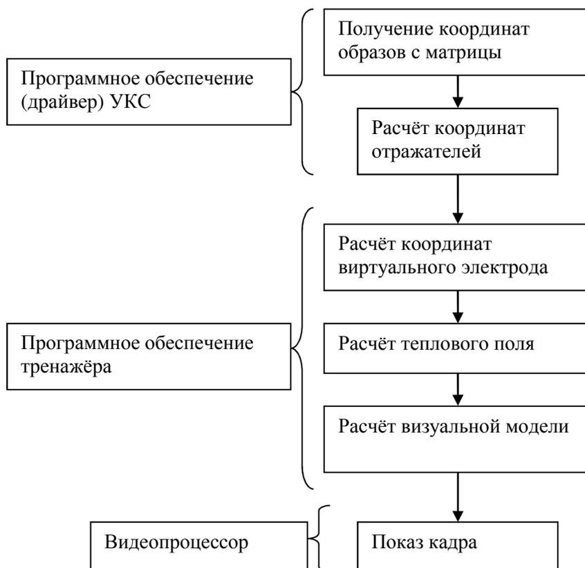
Рис. 1. – Схема преобразования данных
