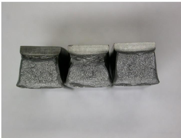
**Рис. 6.** – Вид излома образцов с острым надрезом из стали 10ГН2МФА, испытанных на ударный изгиб при комнатной температуре в полосе разброса в верхней части интервала ВХП. Вверху под надрезом видна зона подрастания вязкой трещины, различающаяся для всех приведенных образцов; в центре – блестящая зона макроскопически хрупкого разрушения; по бокам участки среза; внизу – вязкая зона сжатия. Профиль излома имеет искаженную деформацией форму
