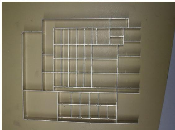
**Рис. 1.** – Внешний вид экранирующих перегородок
