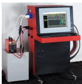
Рисунок 1. Сварочный регистратор ИНЭМ-ЭКСПЕРТ Figure 1. Recorder of welding processes INEM-EXPERT
