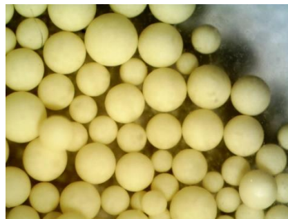
Рисунок 2. Исследуемый опытный модифицированный образец ТВЭКС ТОДГА
