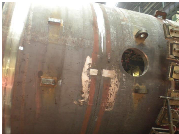
Рисунок 2. Обечайка с отверстием под установку патрубка
