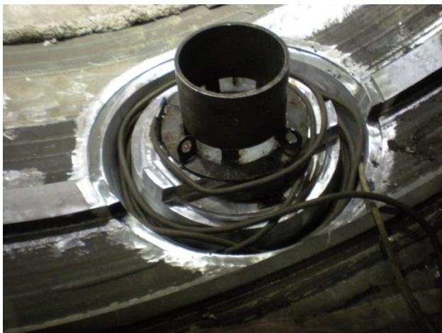
Рисунок 7. Пример намотки кабеля в внутреннюю разделку в корпусе для размагничивания при сборке обечайки и патрубка
