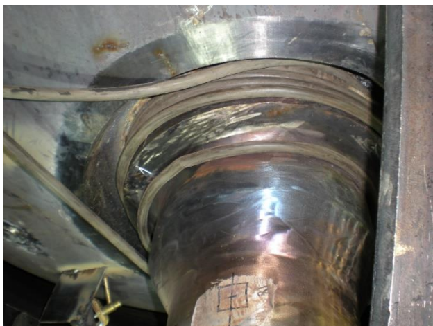
Рисунок 6. Пример намотки кабеля на патрубок для размагничивания при сборке обечайки и патрубка Figure 6. Example of winding the cable on the nozzle for demagnetization during the assembly of the shell and the nozzle
