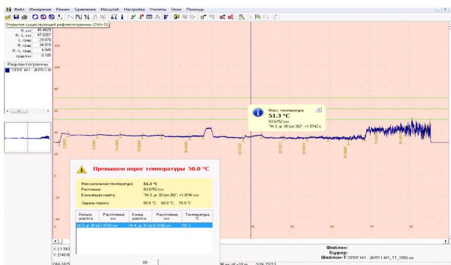
Рисунок 4 – Термограмма плавки гололеда постоянным током. ВЛ 220 кВ РП 220кВ Волгодонск-Зимовники [Thermogram of smelting ice with direct current. VL 220 kV RP 220kV Volgodonsk-Zimovniki]
