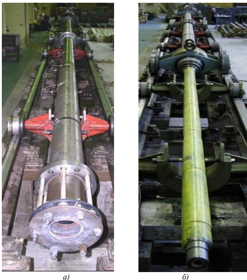
Рисунок 1 – Пушки (вид спереди – сверху): а) – пороховая пушка ПБП-85; б) – легкогазовая пушка ЛГП-85/23 [Cannons (front view – top): a) – PBP-85 powder gun; b) – light gas gun LGP-85/23]
