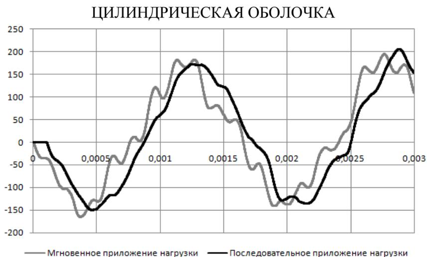
Рис. 10. – График перегрузки точечной массы  $m=10$  кг, подвешенной на упругих элементах
