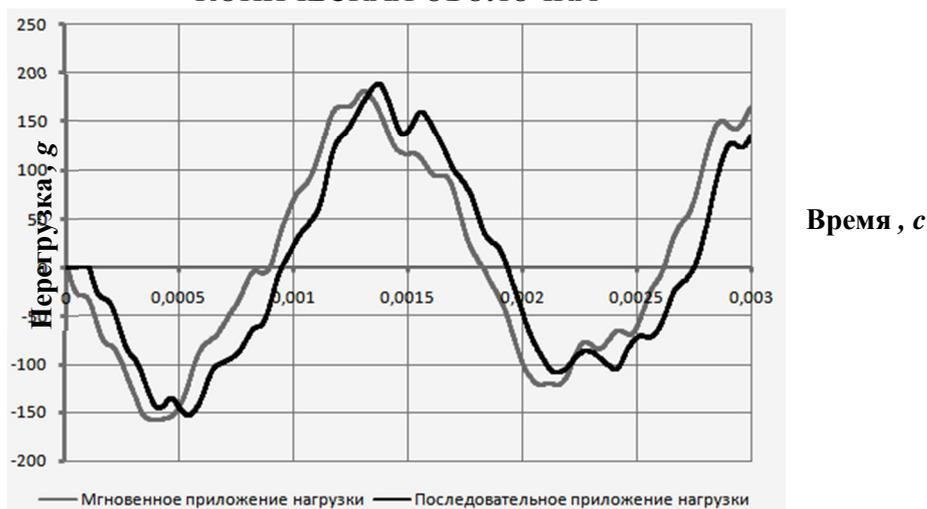
Рис. 7. – График перегрузки точечной массы  $m=10$  кг, подвешенной на упругих элементах
