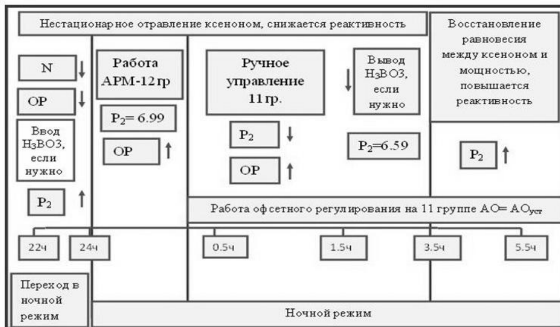
Рисунок 3 – Алгоритм управления реактором в ночном интервале времени для реализации суточного маневренного режима при минимизации водообмена [Algorithm for controlling the reactor in the night time interval for the realization of the daily maneuvering regime with minimization of the water exchange]
