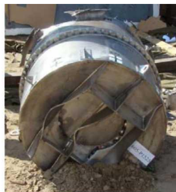
Рис. 10. – Вид на макет ТУК-145/С со стороны, противоположной удару о мишень
