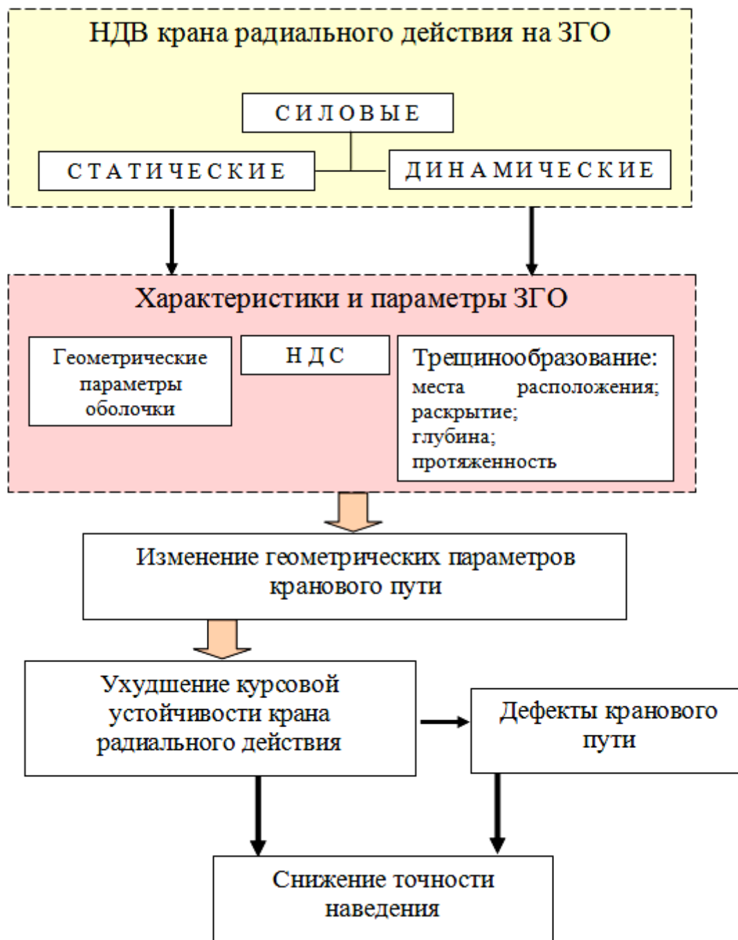
Рис. 1. – Порядок деструктивных воздействий и их последствия для комплекса ЯТ – технологическое оборудование (ТО) реакторного отделения – ЗГО
