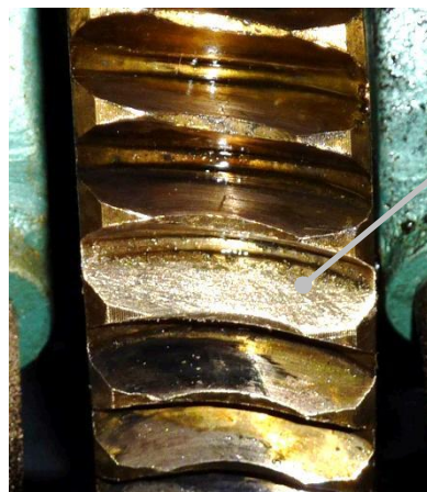
Рисунок 3 - Внешний вид подпиленной контактной поверхности зуба червячного колеса
