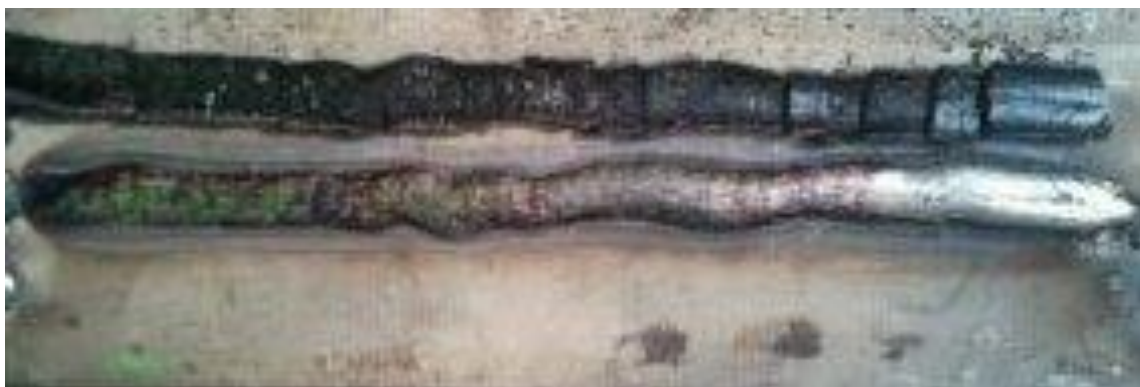
Рисунок 1.2 – Внешний вид образца для подбора режима сварки под флюсом ФКБ-4 в сочетании с проволокой ЭП792-ВИ
