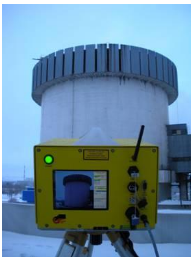
Рисунок 5 – Результаты лазерного сканирования фактической геометрии защитной оболочки
