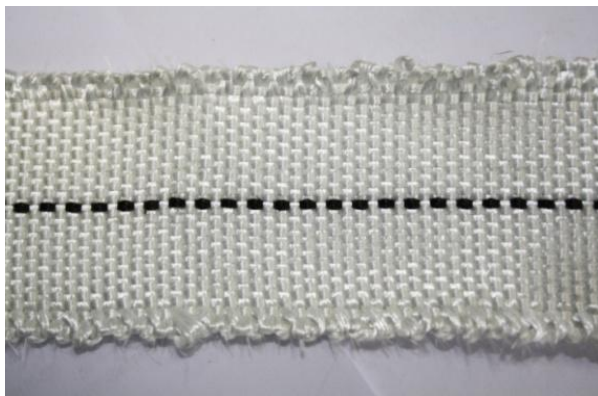
Рисунок 2.3 – Внешний вид гибкой однослойной подкладной ленты ЛМС - 3
