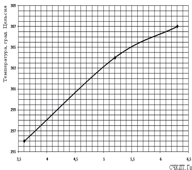
Рисунок 5 - График зависимости температуры в области полосы пропускания от собственных частот колебаний давления теплоносителя
