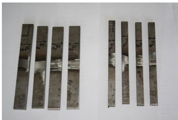
Рисунок 3.1 – Образцы для механических испытаний на растяжение и статический изгиб
