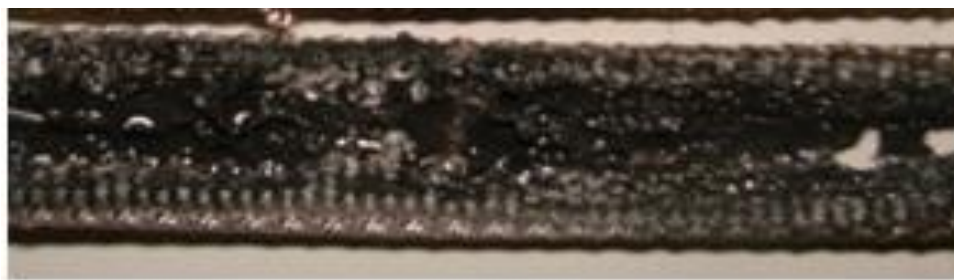
Рисунок 2.7 – Внешний вид подкладной ленты после сварки
