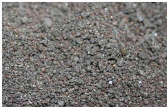
Рисунок 1.1 – Внешний вид керамического флюса ФКБ-4 С использованием флюса ФКБ-4 в сочетании с проволоками марок Св-01Х12Н2
