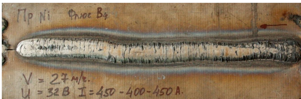
Рисунок 1.3 – Внешний вид образца для подбора режима сварки под флюсом ФКБ – 4 в сочетании с проволокой Св-03Х19Н60М15
