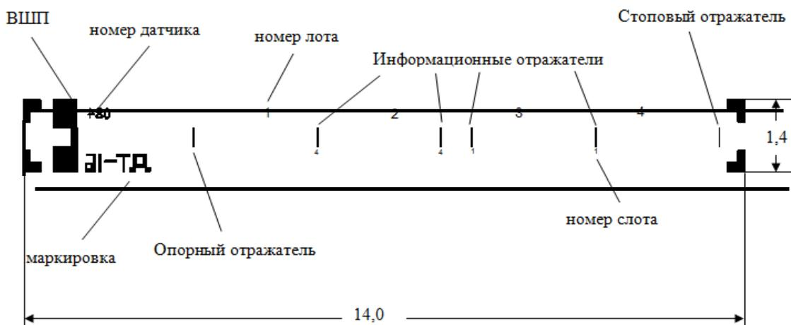
Рис. 1. – Конструкция датчика температуры
