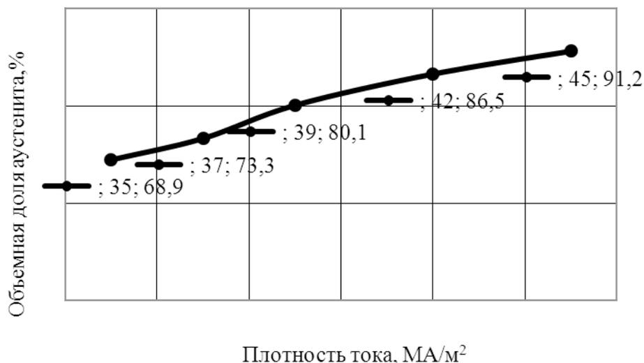
**Рис. 1.** Зависимость объемной доли аустенита от плотности тока.
