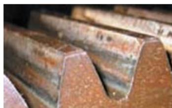
Рисунок 2 – Отсутствие деформаций – признак действия номинальной нагрузки:
