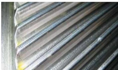
Рисунок 6 – Окислительный износ поверхности зубчатой передачи при жидкостном трении
