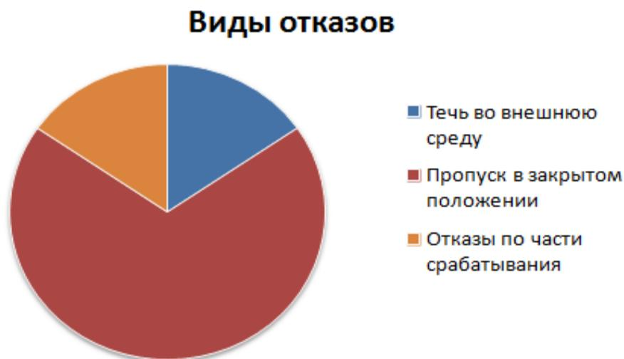
Рисунок 1 – Виды отказов арматуры с ручным приводом
