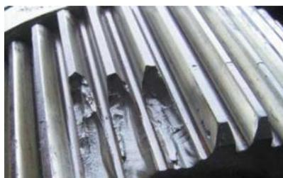
Рисунок 4 – Излом зубьев из-за воздействия динамических ударов
