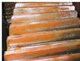
Рисунок 5 – Следы коррозии на поверхности зубьев:
