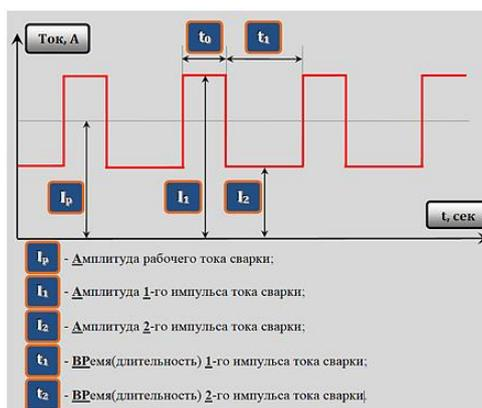
Рисунок 1 – Выбор формы сварочного тока в импульсном режиме
