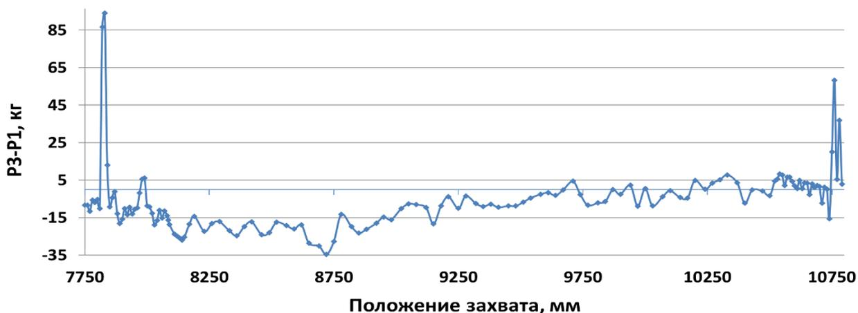
Рисунок 3 – Прирост сил трения при выгорании топлива в течение двух кампаний
