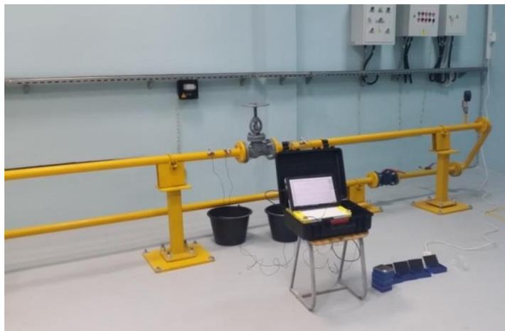
Рисунок 1 – стенд контроля протечек
