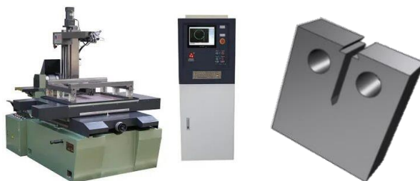
Рисунок 2 – Электроэрозионный станок и обрабатываемый на нем образец СТ
