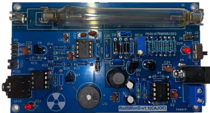
Рисунок 1 – Датчик-сигнализатор на основе микросхем NE555P и ионизационной трубки J305
