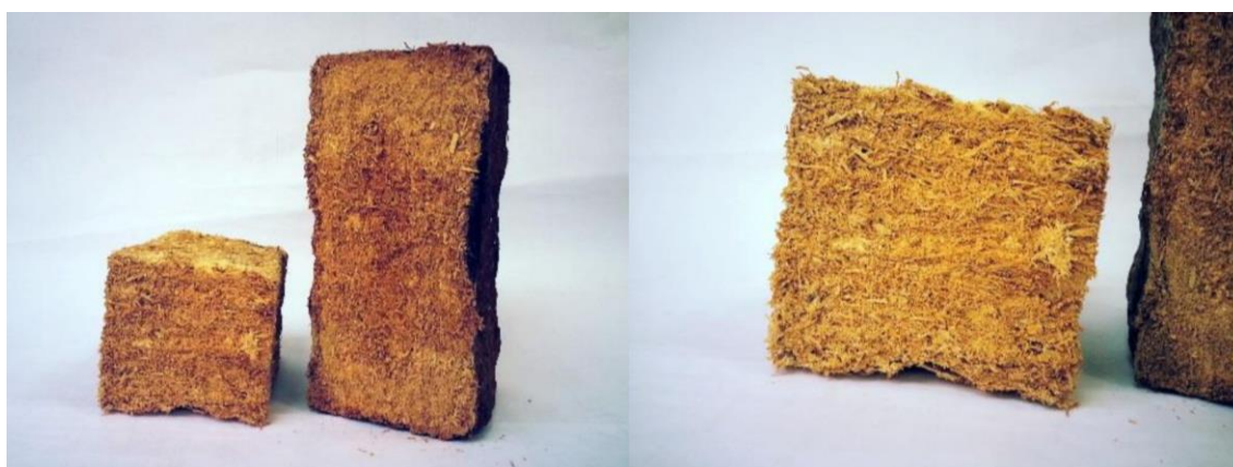
Рисунок 2 – Пробные тела из мицелиального композита
