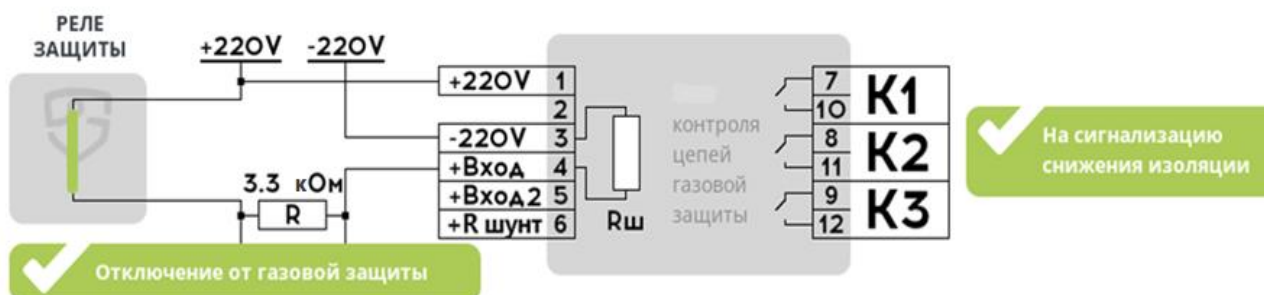
Рисунок 2 – Устройство контроля изоляции в цепях ГЗ
