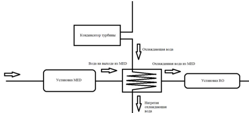
Рисунок 1 – Эталонная модель установки АЭС
