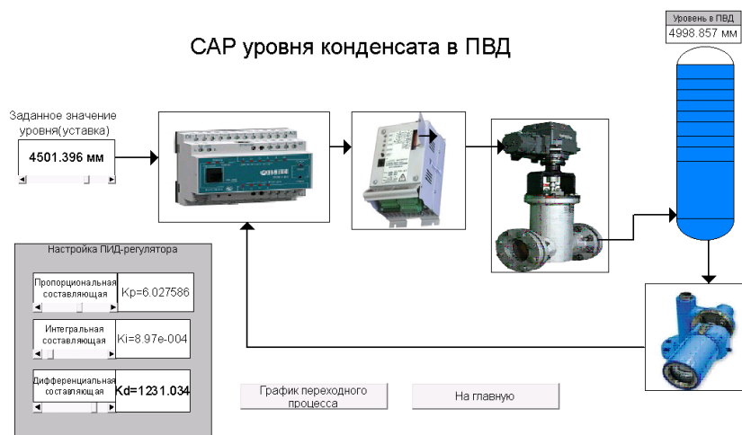
Рисунок 3 – Общая мнемосхема САР уровня в конце моделирования
