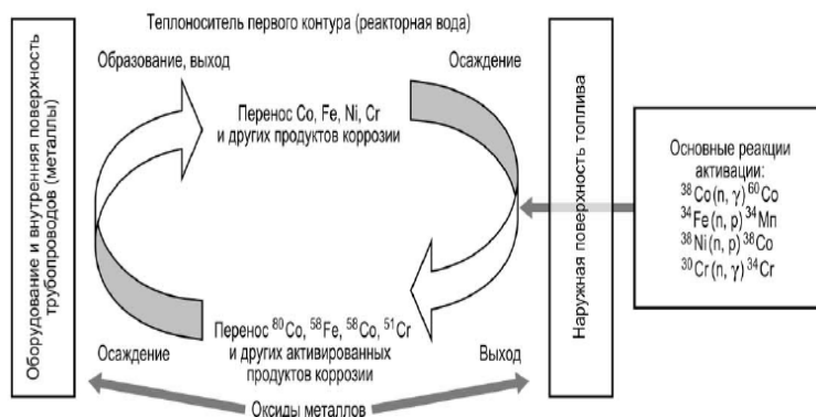
Рисунок 1 – Процесс активации и переноса продуктов коррозии
