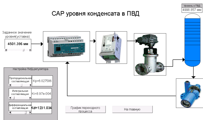
Рисунок 3 – Общая мнемосхема САР уровня в конце моделирования
