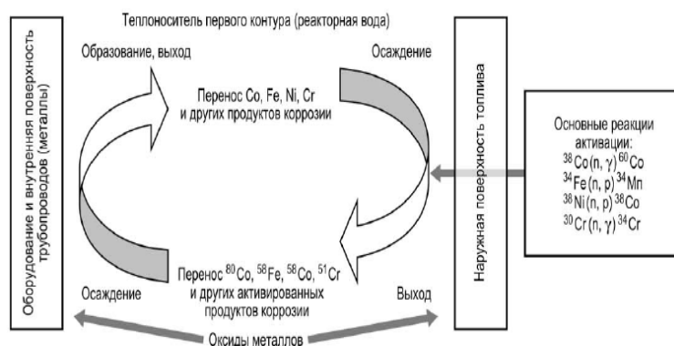
Рисунок 1 – Процесс активации и переноса продуктов коррозии
