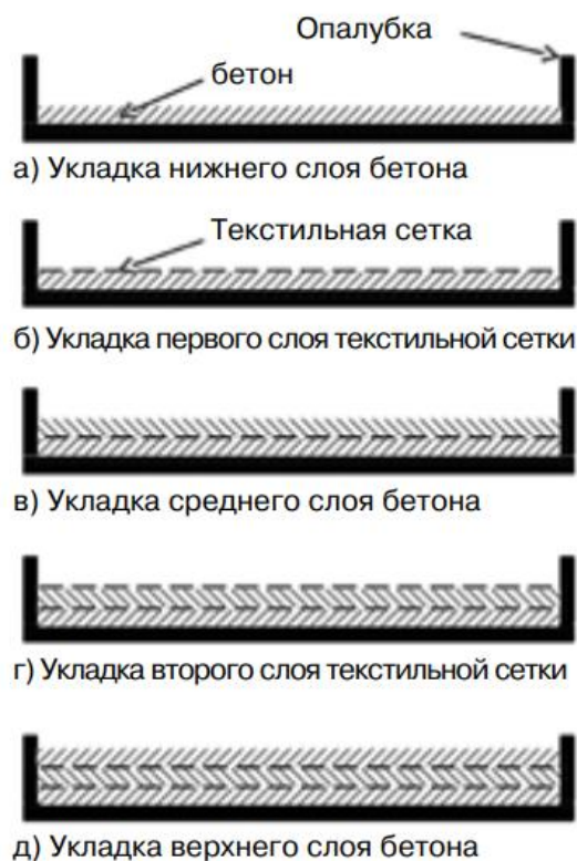
Рисунок 1 - Схема приготовления текстиль-бетона
