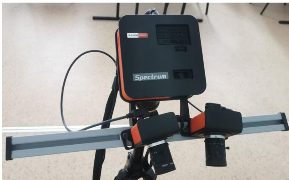
Рисунок 6.1.18. 3D сканер RangeVision Spectrum
