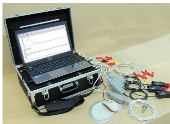
Рисунок 6.1.17. Стенд контроля параметров электроприводного оборудования и вращающихся механизмов «Крона–517 М»
