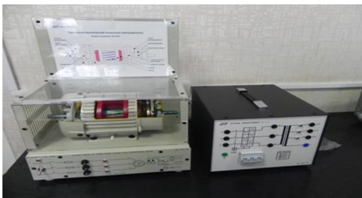
Рисунок 6.1.16. Учебный стенд «Трехфазный явнополюсный синхронный электродвигатель»
