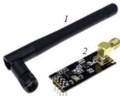
Рисунок 3 – Модуль радиосвязи NRF24L01+PA+LNA, где: 1 – антенна; 2 – NRF24L01+ [Radio communication module NRF24L01+PA+LNA, where: 1 – Antenna; 2 – NRF24L01+
