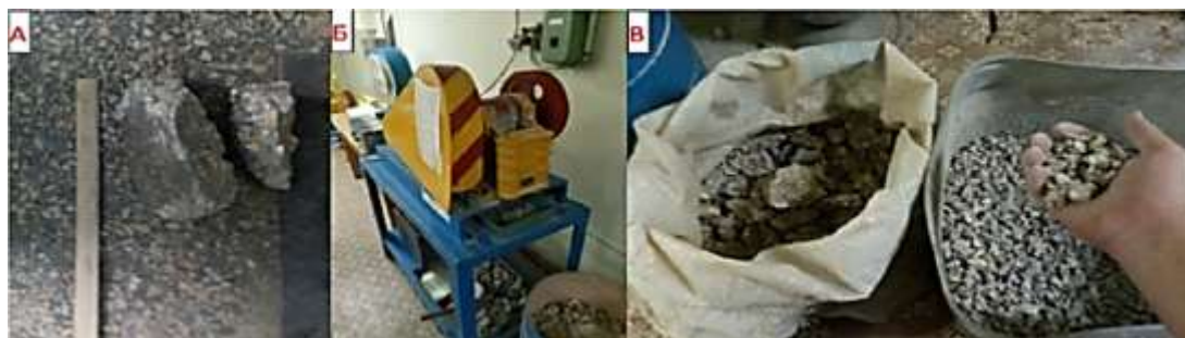
Рисунок 2 – Изготовление бетонного боя: а) демонтированный бетон б) щекодробилка, в) получившийся бой бетона [Production of concrete scraps: a) dismantled concrete b) crusher, c) resulting concrete scrap]
