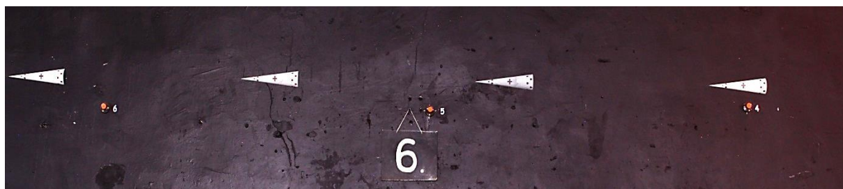
Рисунок 1 – Четыре положения модели, зафиксированные в зоне регистрации отдельного стереопоста в аэробаллистическом эксперименте [Four positions of the model fixed in the registration area of a separate stereo post in an aeroballistic experiment]
