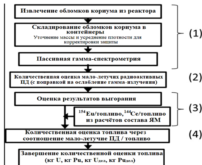
Рисунок 3 – Блок-схема последовательных операций технологии пассивной гамма-спектрометрии для количественного определения ядерных материалов в образце кориума [12] [Block diagram of passive gamma spectrometry technology sequential operations for the nuclear materials quantitative determination in a corium sample]
